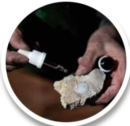
Salzsäuretest: Reagiert das Gestein schäumend, handelt es sich um Kalkstein.
